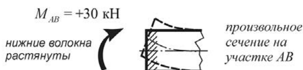
Рис. 3.19. Изгибающий момент на участке AB . Момент левых сил
